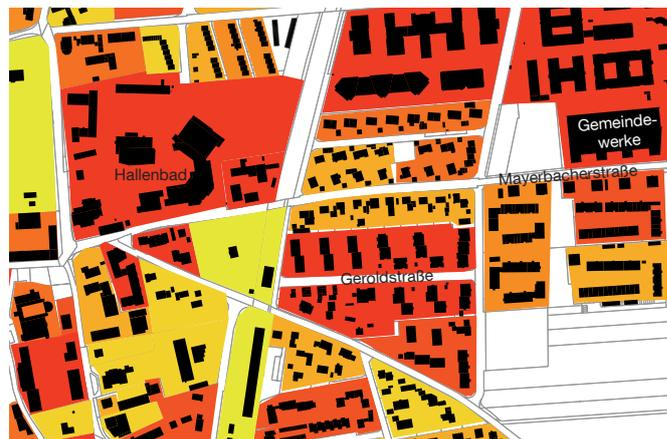
Abb. 5.3: Wärmedichtekarte im Bereich der bestehenden Nahwärmenetze
